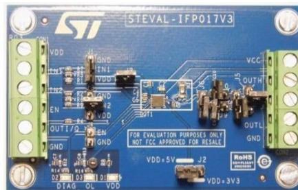
图6 – STEVAL-IFP017V3 具有 L6362A 的所有特性
