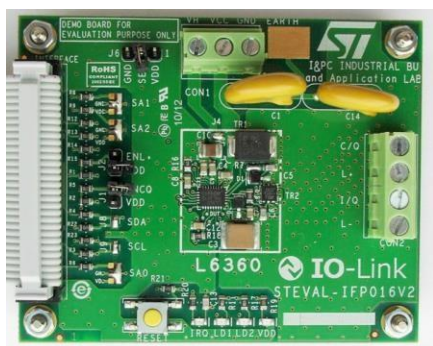
图5 – STEVAL-IFP016V2 具有 L6360 的所有特性
